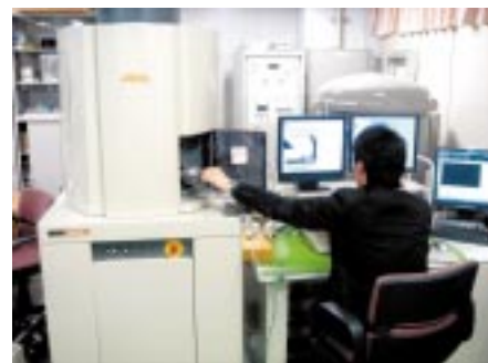
図3 ナノマニピュレーターを搭載した透過型電子顕微鏡“スーパーナノファクトリー”の概観
